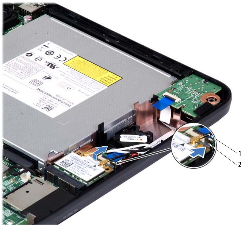
1 Cables de la antena de la minitarjeta (2)      2 Lengüeta
